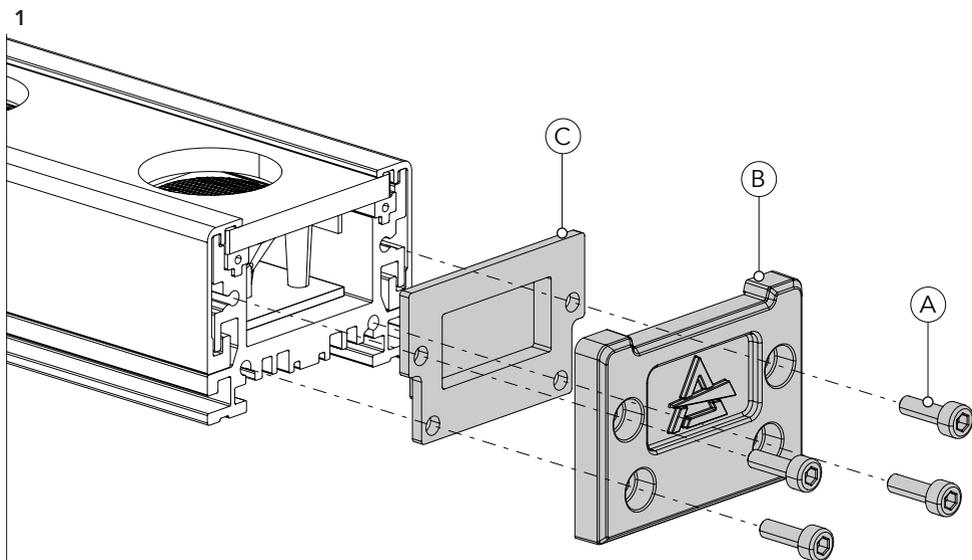
Desserrez et retirez les quatre vis marquées (A) d'un seul côté. Retirez ensuite le cache latéral (B) et la bague en plastique (C).
