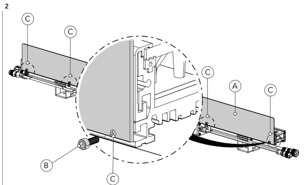
Insérez l'accessoire coupe-flux (A) en montant les quatre vis (B) dans les quatre trous du boîtier (C). Remontez ensuite la bague en plastique, le cache latéral et les quatre vis (voir fig. 1).
