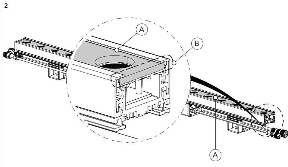
Insérez l'accessoire de filtre de diffusion de lumière (A) dans le guide de quincaillerie du boîtier (B). Remontez ensuite la bague en plastique, le cache latéral et les quatre vis (voir fig.1).
