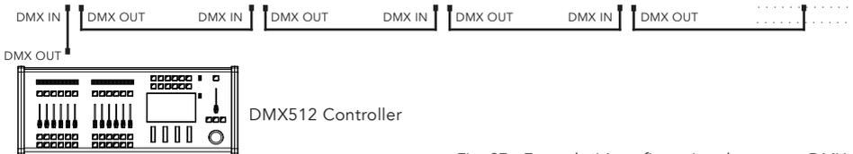
Fig. 07 - Exemple 14 configuration des canaux DMX
