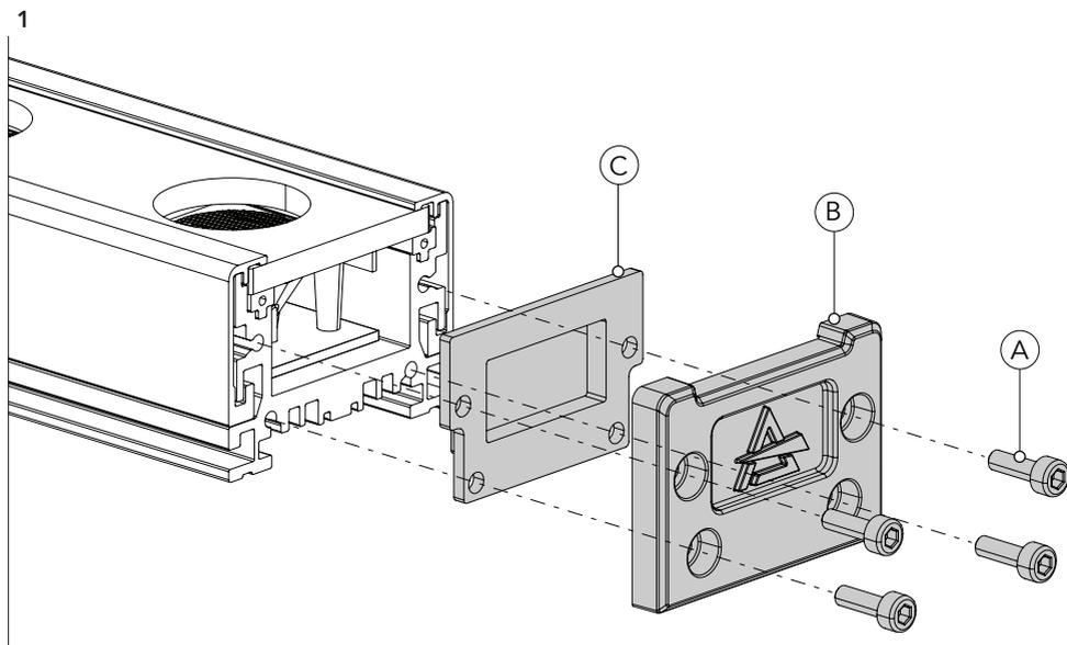
Desserrez et retirez les quatre vis marquées (A) d'un seul côté. Retirez ensuite le couvercle latéral (B) et l'anneau en plastique (C).
